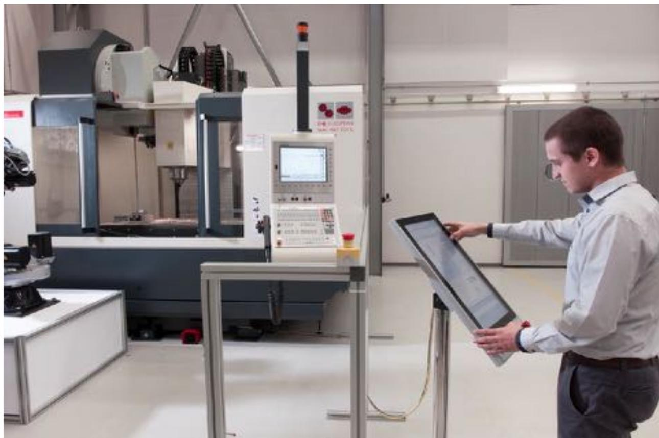
Ячейка образует функциональную производственную единицу, соединяющую станок, робот и измерительную станцию. Единая система решает проприетарную связь с каждым устрой-
